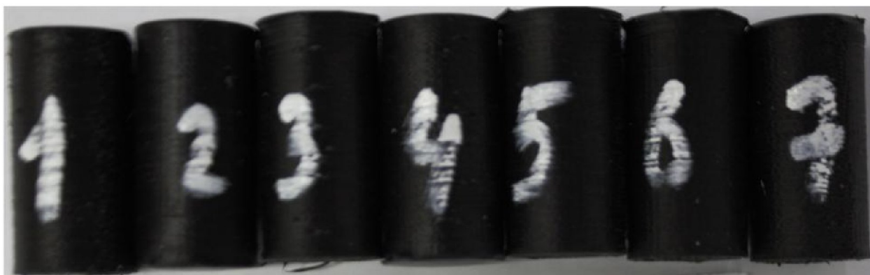
Фотографии элементарных образцов REC RUBBER до испытаний
